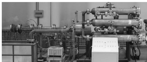
图 1 西北工业大学直连式电阻加热设备
